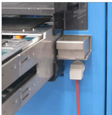
KVT 50-W90 - Sivu 36 Kaapelin sisäänvienti 90 ast. kulmassa KVT-W90 läpiviennillä.
