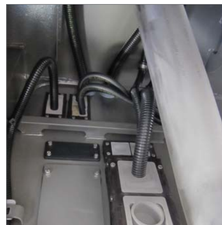
KEL-JUMBO 2 - Sivu 48 / KEL 24|x - Sivu 16 Suojaletkujen ja suurien kaapeleiden ajoneuvon sisäänvienti.
