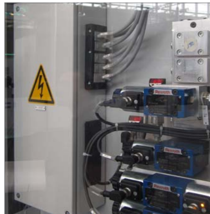
KEL 24|10 - Seite 16 / BPK 24 - Seite 154 Einführung von 6 Leitungen mit nur einer Kabeleinführungsleiste. Ein zweiter Ausbruch ist mit einer Kunststoff-Blindplatte BPK 24 versiegelt.
