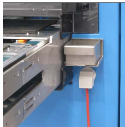
KVT 50-W90 - Seite 36 Teilbare Winkelverschraubung zur Einführung einer Leitung des Bedienpanels.
