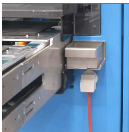
KVT 50-W90 - Strana 36 Zavedení kabelu do ovládacího panelu pod úhlem 90° pomocí KVT-W90.
