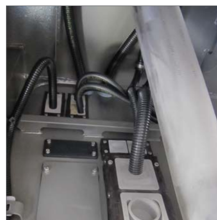
KEL-JUMBO 2 - Strana 48 / KEL 24|x - Strana 16 Zavádění a upevňování chrániček či silných kabelů na mobilních zařízeních.
