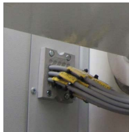
KEL-DPZ B25 - 详见 54 页 包装机械 在很小的空间里引入大量的电缆，防护等级达到IP 66。
