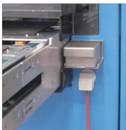
KVT 50-W90 - 详见 28 页 自动柜 使用 KVT-W90 以 90° 的方式把电缆引入控制面板中。
