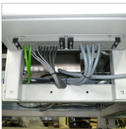
KEL-DPZ 24|x - Página 62 - 63 / FP|AE 330 - Página 149 Entrada de cables en cajas a través de placas de montaje. Se evitan mecanizados en chapa.
